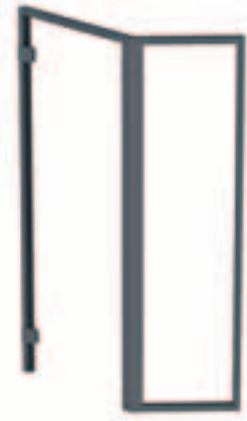
Blockzarge + Wandprofil mit Eckverbindung 135°
