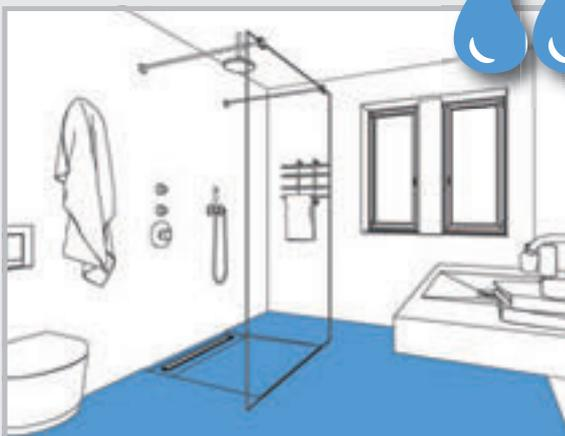
Surfaces fréquemment sollicitées par l'eau sanitaire, particulièrement le sol avec aggravation temporaire due à l'accumulation d'eau
