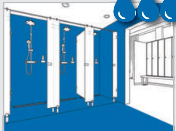
Surfaces très fréquemment ou durablement sollicitées par des projections d'eau et/ou de l'eau sanitaire et/ou de l'eau provenant d'un nettoyage intensif, avec aggravation due à l'accumulation d'eau
