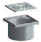
■ TUB-RA-A roosteropname van ABS, incl. standaardrooster van roestvrij staal 120 x 120 mm, totale hoogte 85 mm, universele hoogteaanpas- sing vanaf 2–3 mm mogelijk voor sierpleisters / coating
