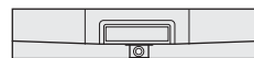
■ TUB-WALL RT 3 1200/200 200 x 1200 x 70/85 mm, met 3-zijdig afschot, inclusief losse dichtingsmanchet 370 x 1300 mm
