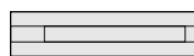
■ TUB-LINE COMBI V RT 1000 (650) met afvoergoot 70 x 650 mm, standaardformaat 200 x 1000 x 67 mm.
