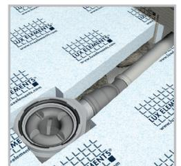
**LUX ELEMENTS®-TUB-LINE BA-S FIRE STOP** se compose d'un siphon de sol TUB-LINE BA-S DN 50 pour carottage Ø 160 mm, vertical, avec obturateurs d'odeurs (hauteur d'eau de siphon 50 mm), avec rallonge TUB-BAZ-VER et insert de protection contre l'incendie (calfeutrement de tuyau).
