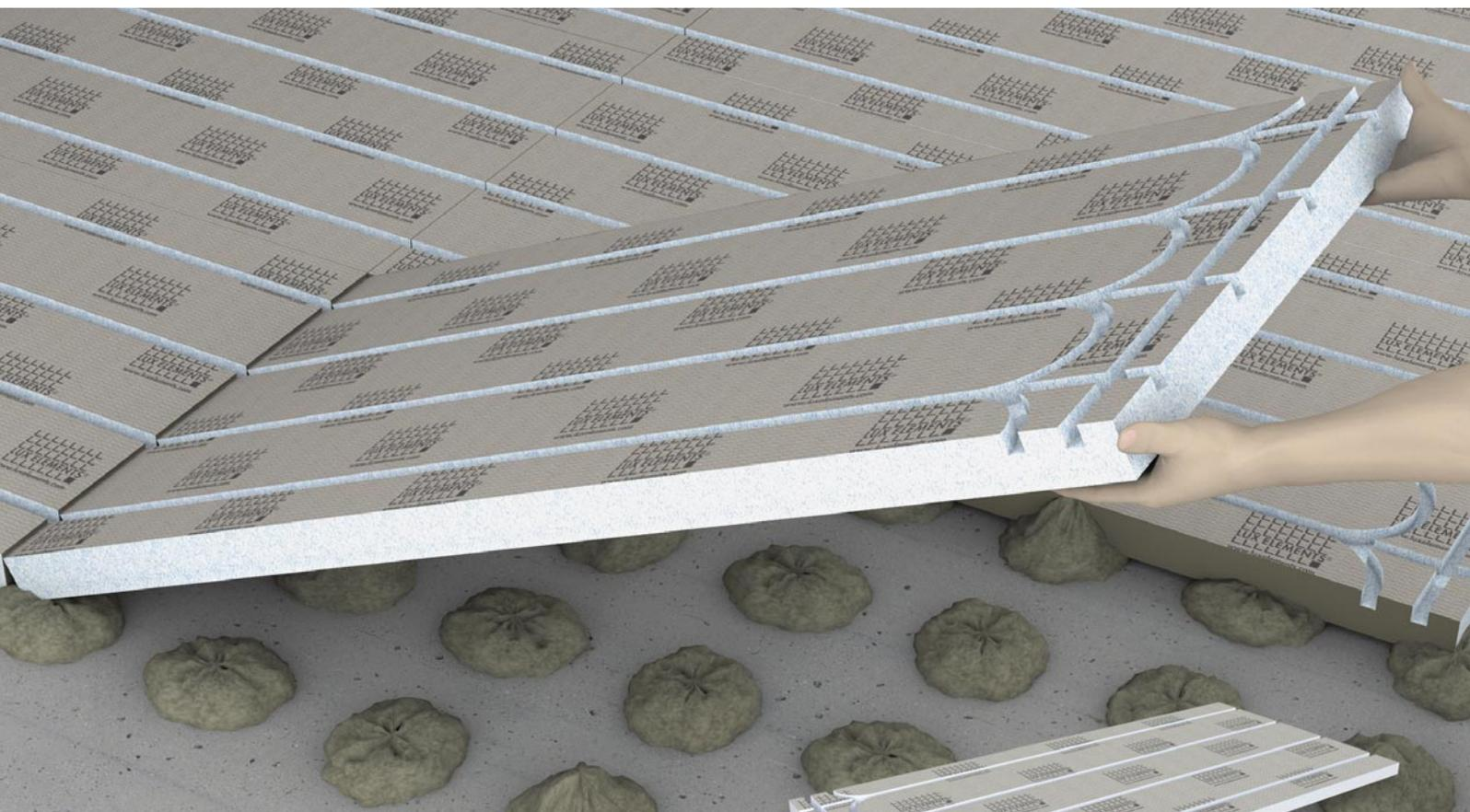
... convient aussi bien pour une utilisation sur des sols en bois que sur des supports minéraux comme le béton ou la chape. FLOOR-WH F 30 doit toujours être collé sur toute sa surface, avec FLOOR-WH F 50 le collage par plot est possible (distance entre les plots  $\leq$  200 mm). Pour les sols en bois, un collage sur toute la surface est toujours nécessaire !
