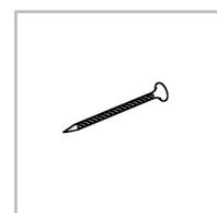
( p ) Roestvrijstalen schroeven 4 x 50 mm met verzonken kop voor bevestiging in PRO-MAK (3 stuks per meter)
