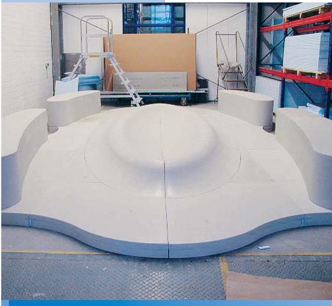
Le bassin disposé au centre avec ses banquettes de repos en forme de gouttes lors de la phase de production. Suite à leur production, les éléments ont été assemblés dans les locaux de Lux Elements.
