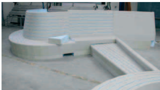
Alle hardschuim draagelementen werden in de fabriek van Lux Elements precies op maat vorgefabriceerd, in de eigen productiehallen opgebouwd en op nauwkeurigheid gecontroleerd.
